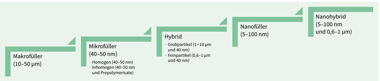
Abb. 3: Chronologische Entwicklung der Komposite anhand der Änderungen der Füllkörper nach Ferracane [3]
