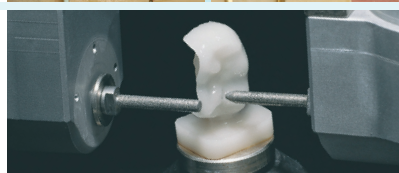
Verfahren zur computer-gestützten, direkten Herstellung von gefrästen Keramik-Inlays, Onlays, Teilkronen, Veneers, Kronen und Brücken
