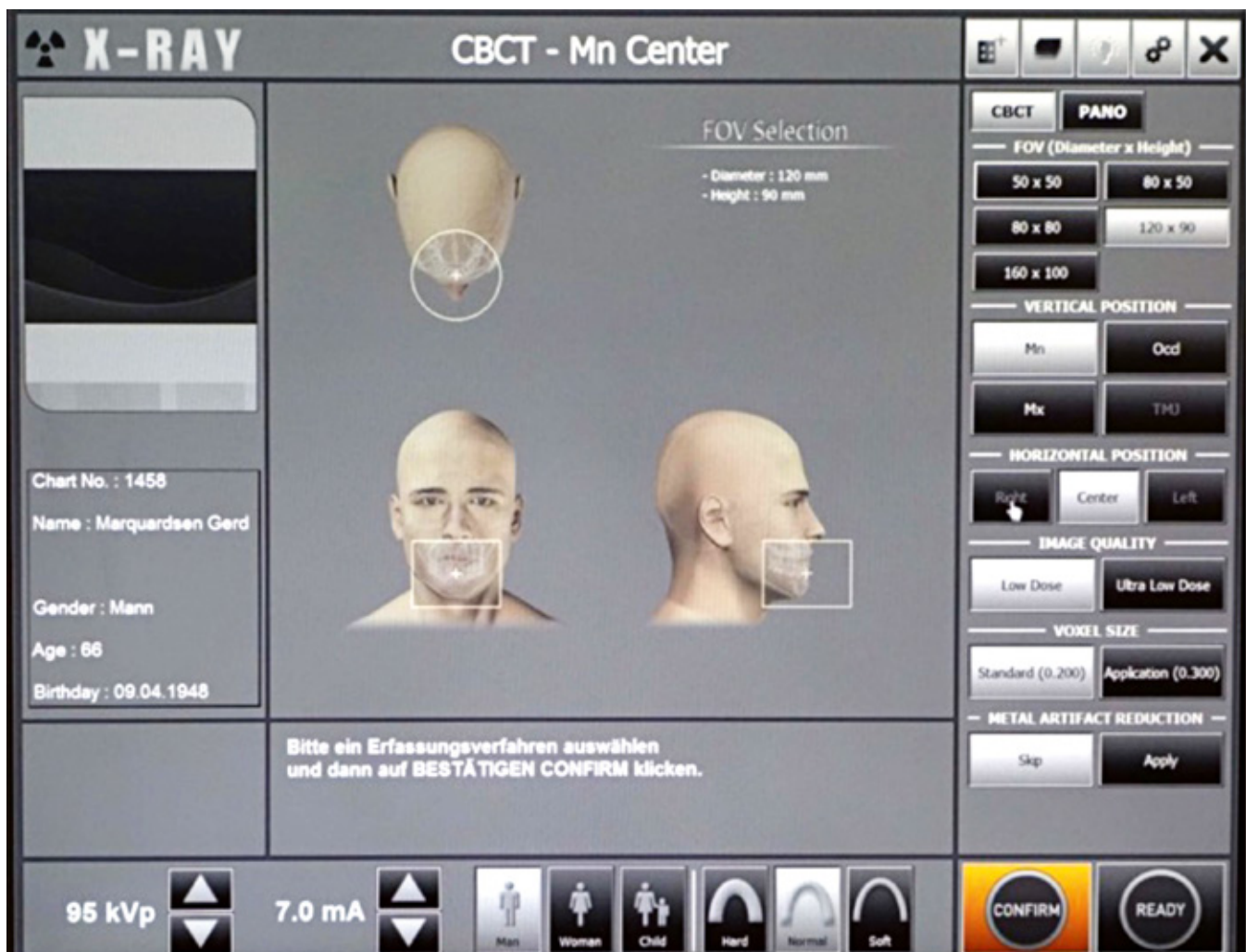
Abb. 4 Beispiel für die Einstellmöglichkeiten beim Green 3D (Fa. Vatech, Hwaseong, Republik Korea). Gewählt werden kann das „Field of view“ (FOV), die Bildqualität, die Voxelgröße, eine Möglichkeit zur Artefaktreduktion sowie die kVp/mA-Werte (durch Auswahl des Patientensymbols).
