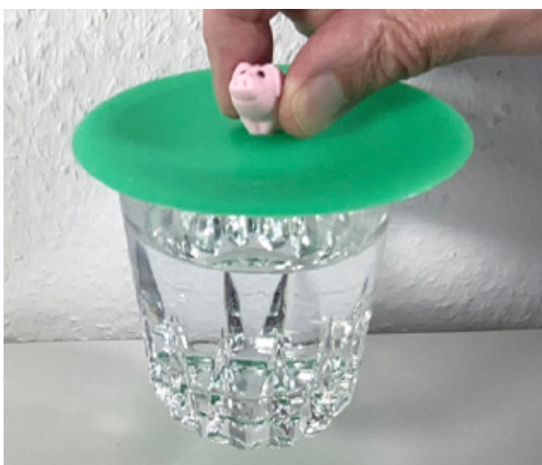
Abb. 2: Das Saugnapf Prinzip: Geschlossener Saugnapf hält das Gewicht
