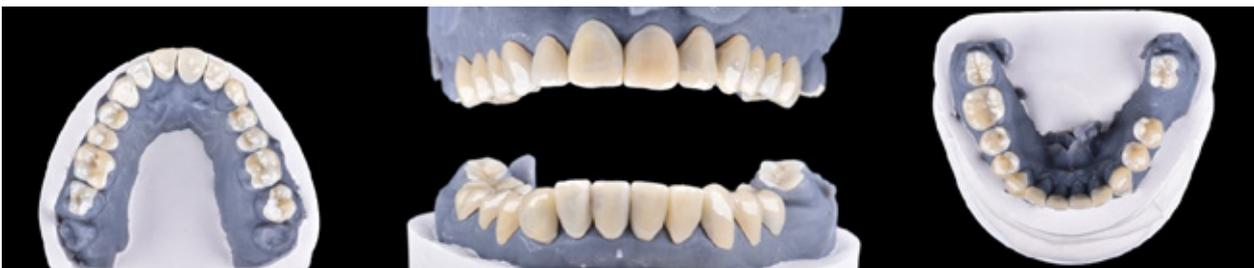
Abb. 6: 27 gedruckte Restaurationen im Ober- und Unterkiefer mit einer Schichtstärke von partiell unter 1 mm: Verschiedene Restorationsgeometrien sind individuell druckbar (Table Tops, Veneers, Kronen), um eine noninvasive Therapie zu ermöglichen.
